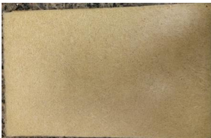
Figura 9. Placa de Fibra de Pupunha pós curada.
