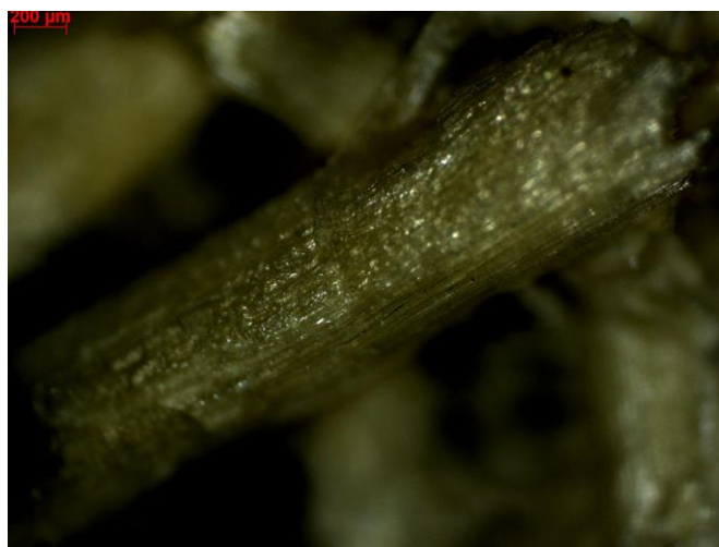
Figura 13. Microscopia óptica da placa de fibra de pupunha não tecida.
