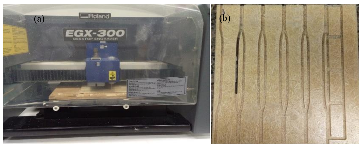
Figura 10. Imagem do (a) corte dos corpos de prova e (b) placa após o corte na fresa.
